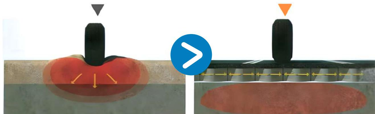
Cuando se aplica carga a un terreno sin reforzar, el suelo colapsa debido al asentamiento del terreno.
