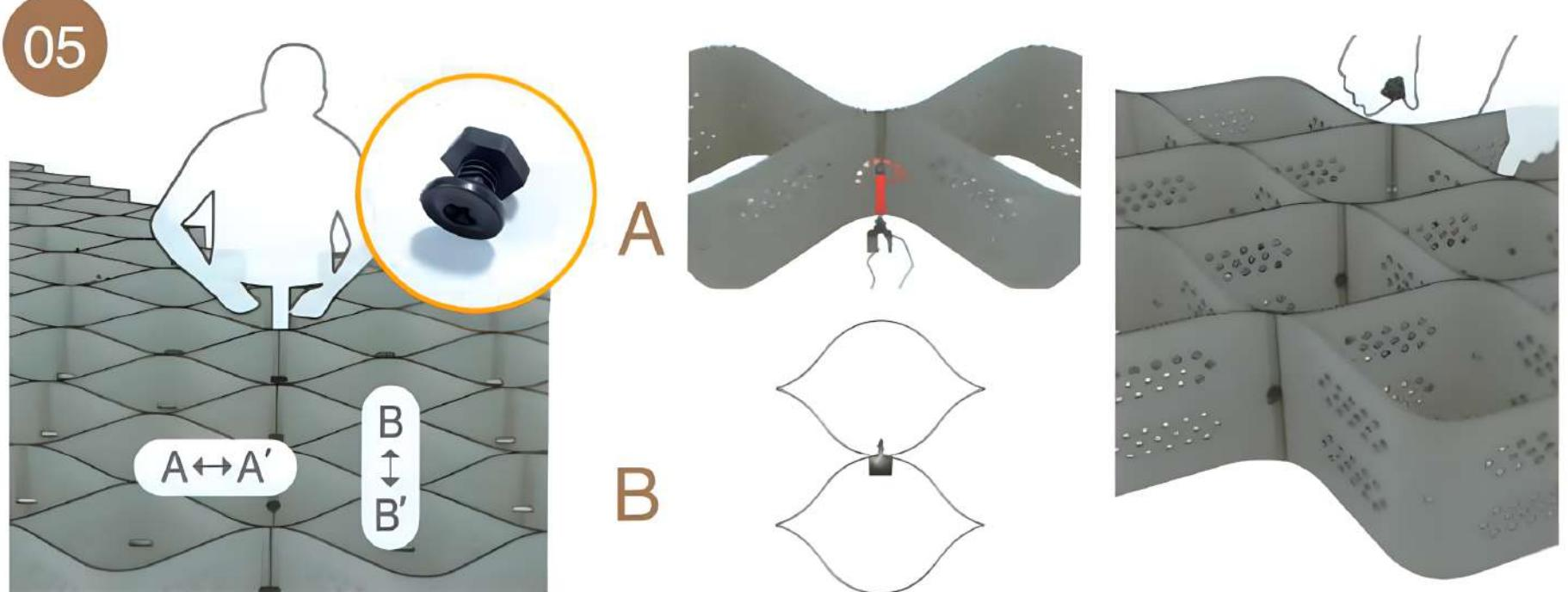
Conecte los laterales de la GEOCELDA con la llave de unión (GEOCELL key) de forma horizontal (A-A') y vertical (B-B').
